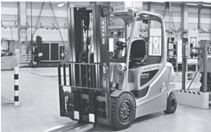
Ex-Schutz-Version mit gekapselten elektrischen Komponenten
